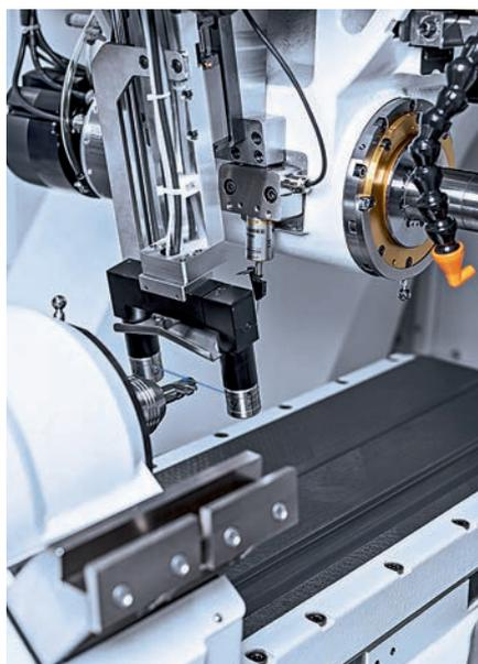
WALTERの工具研削盤における測定システムのレーザーコンターチェック
