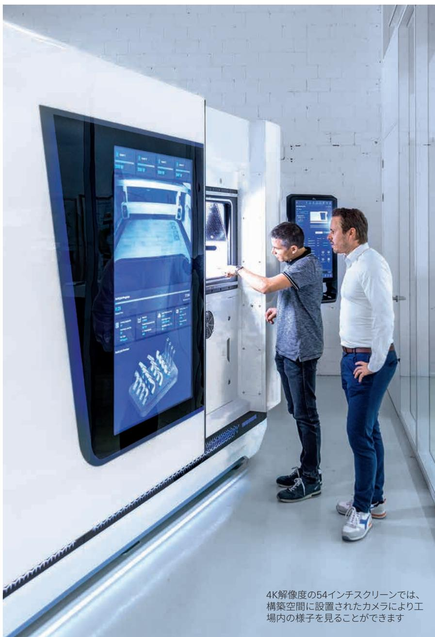
4K解像度の54インチスクリーンでは、構築空間に設置されたカメラにより工場内の様子を見ることができます
