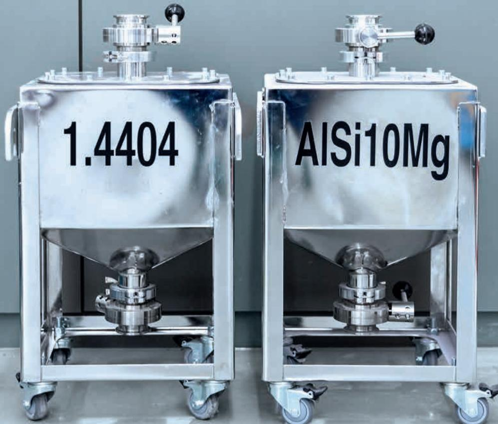
IRPDのジョブショップでは、ローラー付きの37リットルの専用コンテナに、さまざまな金属粉末が種類別に保管されています。ここにあるラベルは、合金の略です。ステンレス鋼(左)およびアルミニウム・ケイ素(右)
