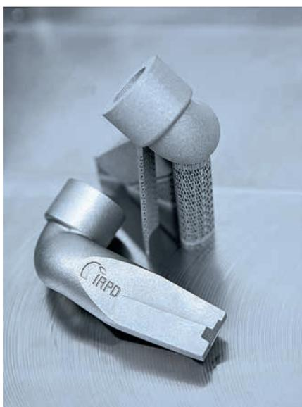
それは、IRPDがBLOHM JUNGと共同で開発、最適化したAMプロセスによる冷却ノズルです。
