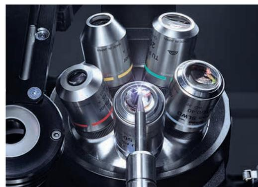
HELICHECK NANOの顕微鏡光学系は、ナノメートル領域での測定を可能にします
