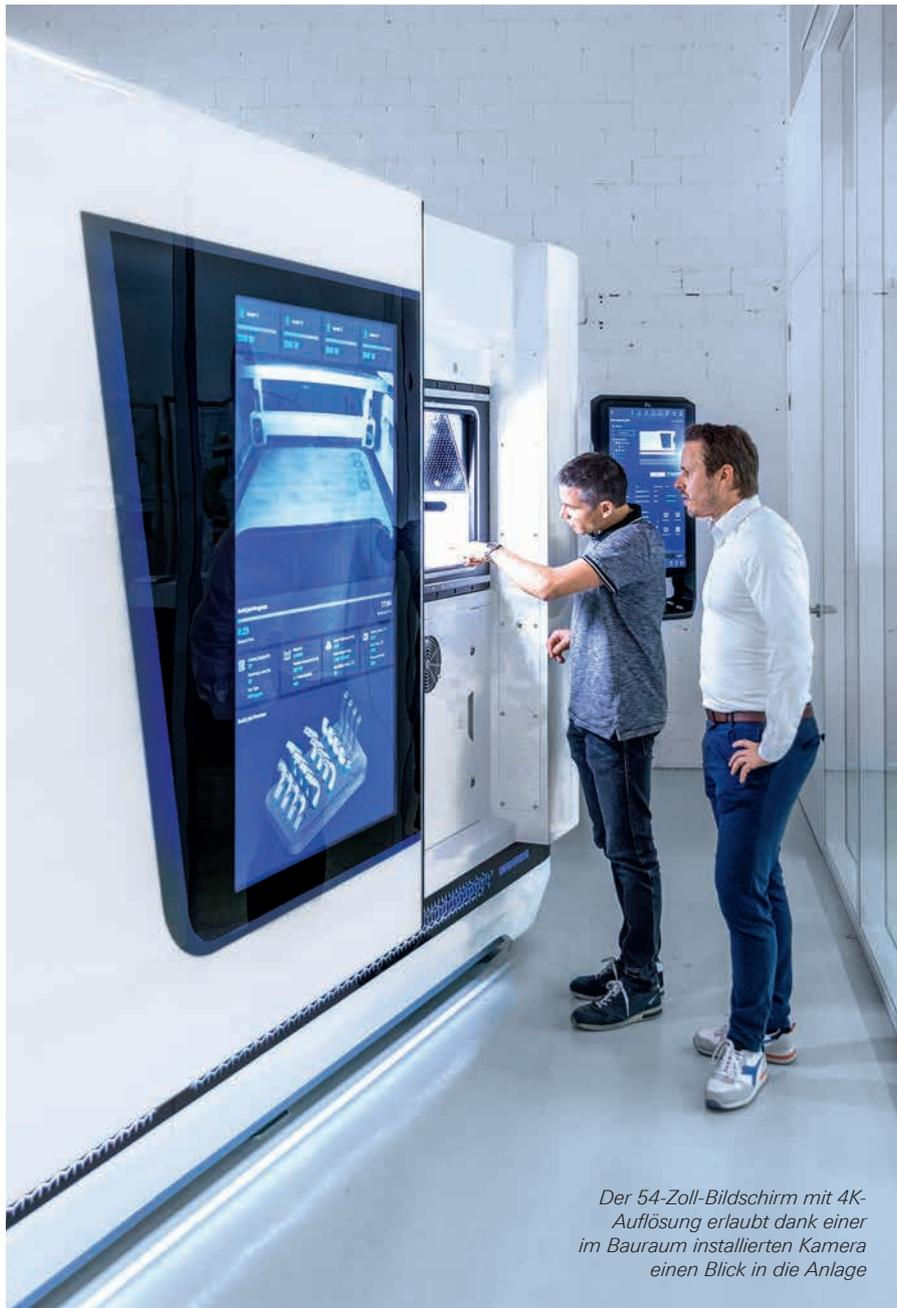
*Der 54-Zoll-Bildschirm mit 4K-Auflösung erlaubt dank einer im Bauraum installierten Kamera einen Blick in die Anlage*
