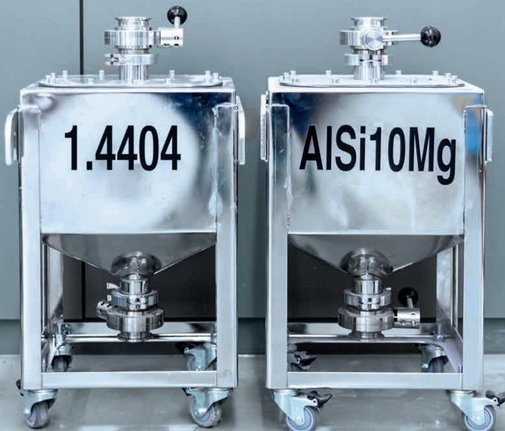
*In 37-Liter-Spezialbehältern mit Rollen werden die unterschiedlichen Metallpulver sortenrein im IRPD-Job-Shop gelagert. Die Beschriftungen hier stehen für die Legierungen: Edelstahl (l.) und Aluminium-Silizium (r.)*
