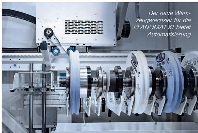
Der neue Werkzeugwechsler für die PLANOMAT XT bietet Automatisierung
