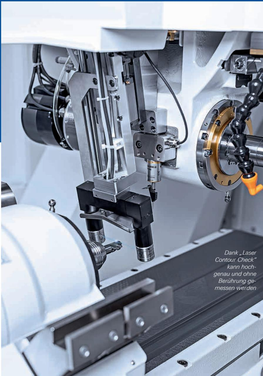
*Dank „Laser Contour Check“ kann hochgenau und ohne Berührung gemessen werden*
