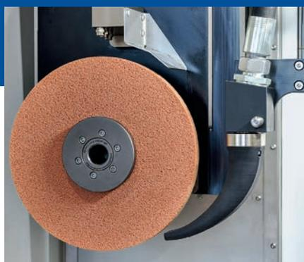
Alimentazione di refrigerante a comando NC e pulizia delle mole ad alta pressione integrata
