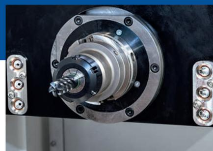
Anche il supporto della mola per gli utensili di fresatura e foratura viene raffreddato in modo mirato
