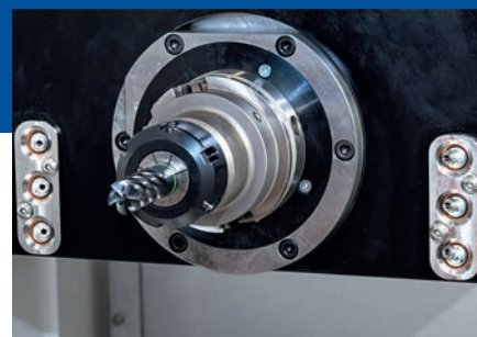
Kühlmitteldüsen am Schleifsupport für Fräs- und Bohrwerkzeuge
