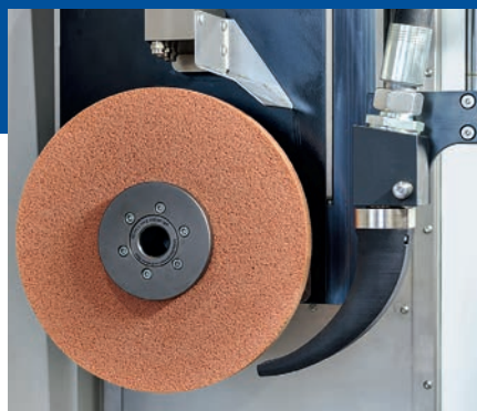
NC-gesteuerte Kühlmittelzuführung und integrierte Hochdruck-Schleifscheibenreinigung
