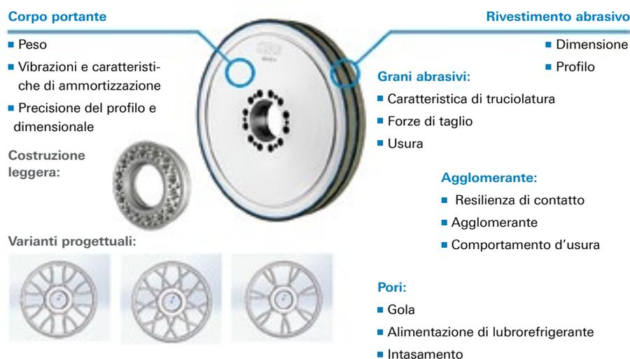
Fig. 1: Struttura di utensili di rettifica ad alte prestazioni e varianti di corpo portante
