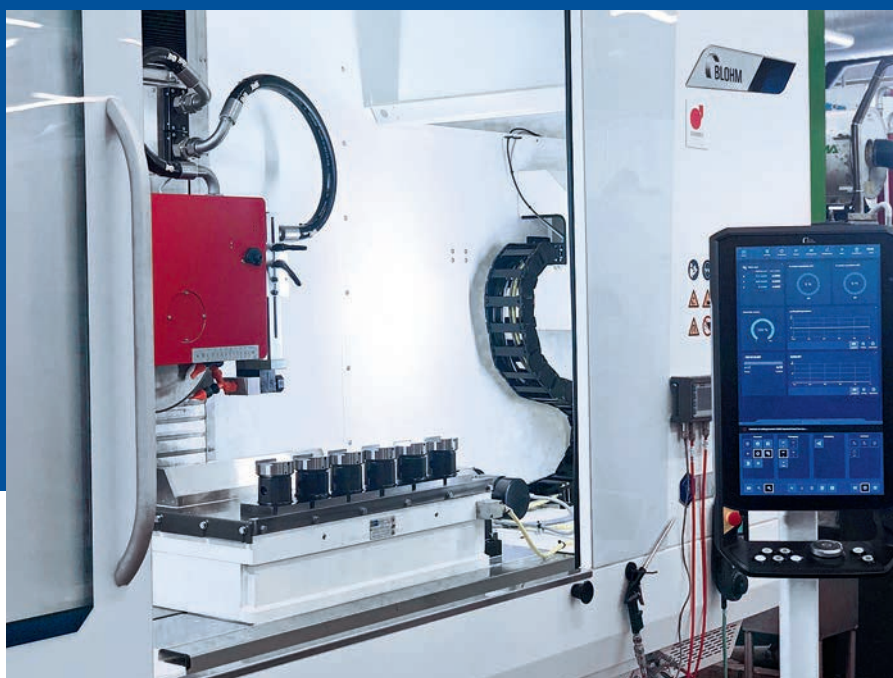
Usinage de porte-outils modulaires de précision sur la PLANOMAT XT 408 avec écran tactile C.O.R.E.
