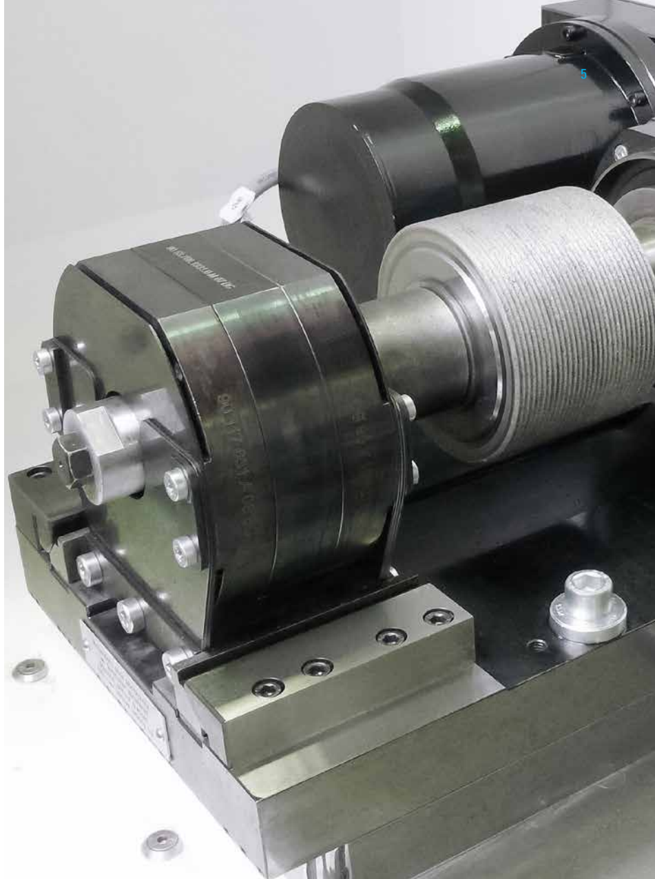
▲ Dispositif de dressage PA-TL 200S monté sur table pour rouleaux profilés diamantés jusqu'à 200 mm de largeur ou avec rouleaux de formage diamantés universels et outil de pré-profilage pour dressage à trajectoire contrôlée avec dispositif de changement rapide pour le mandrin de rouleau.
